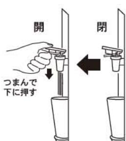
ボトルをセットしたら、すぐ図のように温水フォーセットを下に押し続け、温水タンク内のエアー抜きを行ってください。約1分程度温水フォーセットより水が出ます。水が出たらエアー抜きが完了です。
