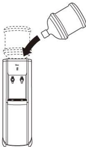
ウォーターガードの中央部のパイプヘボトルを逆さまにして手早くしつかり差し込みます。
