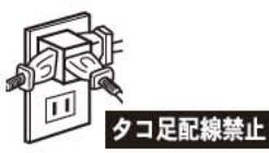
電源プラグをコンセントに差し込み、背面にある温水スイッチをONにします。冷水スイッチはありませんが、この時点で自動的に冷却も開始されます。尚、コンセントのタコ足配線は発熱し、火災の恐れがありますので単独で使用してください。
