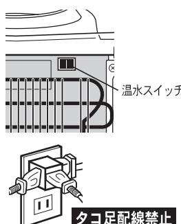
電源プラグをコンセントに差し込み、背面にある温水スイッチをONにします。冷水スイッチはありませんが、この時点で自動的に冷却も開始されます。尚、コンセントのタコ足配線は発熱し、火災の恐れがありますので単独で使用してください。
