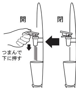
ボトルをセットしたら、すぐ図のように温水フォーセットを下に押し続け、温水タンク内のエアーバッキングを行ってください。約1分程度温水フォーセットより水が出ます。水が出たらエアーバッキングが完了です。
